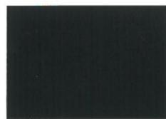
サーモンブラック 日射反射率 41.6(22.0) 明度 25.1
