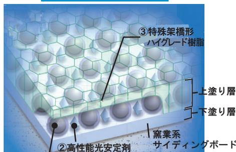
①高耐候酸化チタン樹脂劣化の原因物質「ラジカル」の発生をハイレベルで抑制
