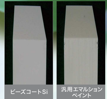
▲ 屋外暴露による汚染の比較(1年間) ※ その他ビーズコートシリーズ製品にも同様の効果が認められます。
