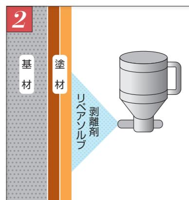
旧塗膜の上からスプレーガン、ローラー、刷毛等を使用し、剥離剤を塗布します。
