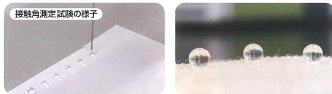
【接触角測定】綿素材を使用し行った場合は超撥水を確認
