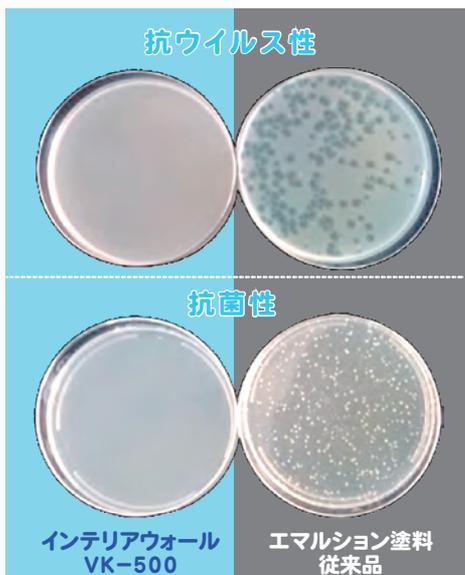
塗膜から回収した、ウイルス培養液 (写真上) または菌 (写真下) をシャーレで培養した様子
