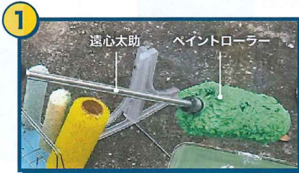
遠心太助に塗料を含んだ使用済みペイントローラーをセットします。
